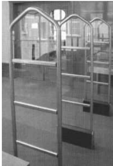
Abbildung 4: Lesegerät mit großer Reichweite als Ein- bzw. Ausgangsschleuse 98
