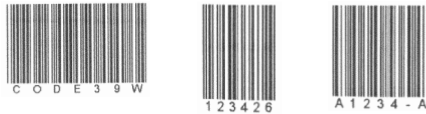
Abbildung 2: Die Strichcodes „Code 39“ 29 (links), „Code 2/5 Interleaved“ 30 (Mitte) u. „Code Codabar“ 31 (rechts)
