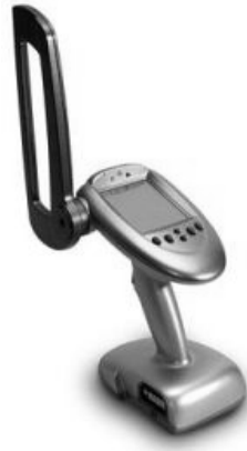
Abbildung 6: Lesegerät mit geringer Reichweite als mobiles Handlesegerät 104
